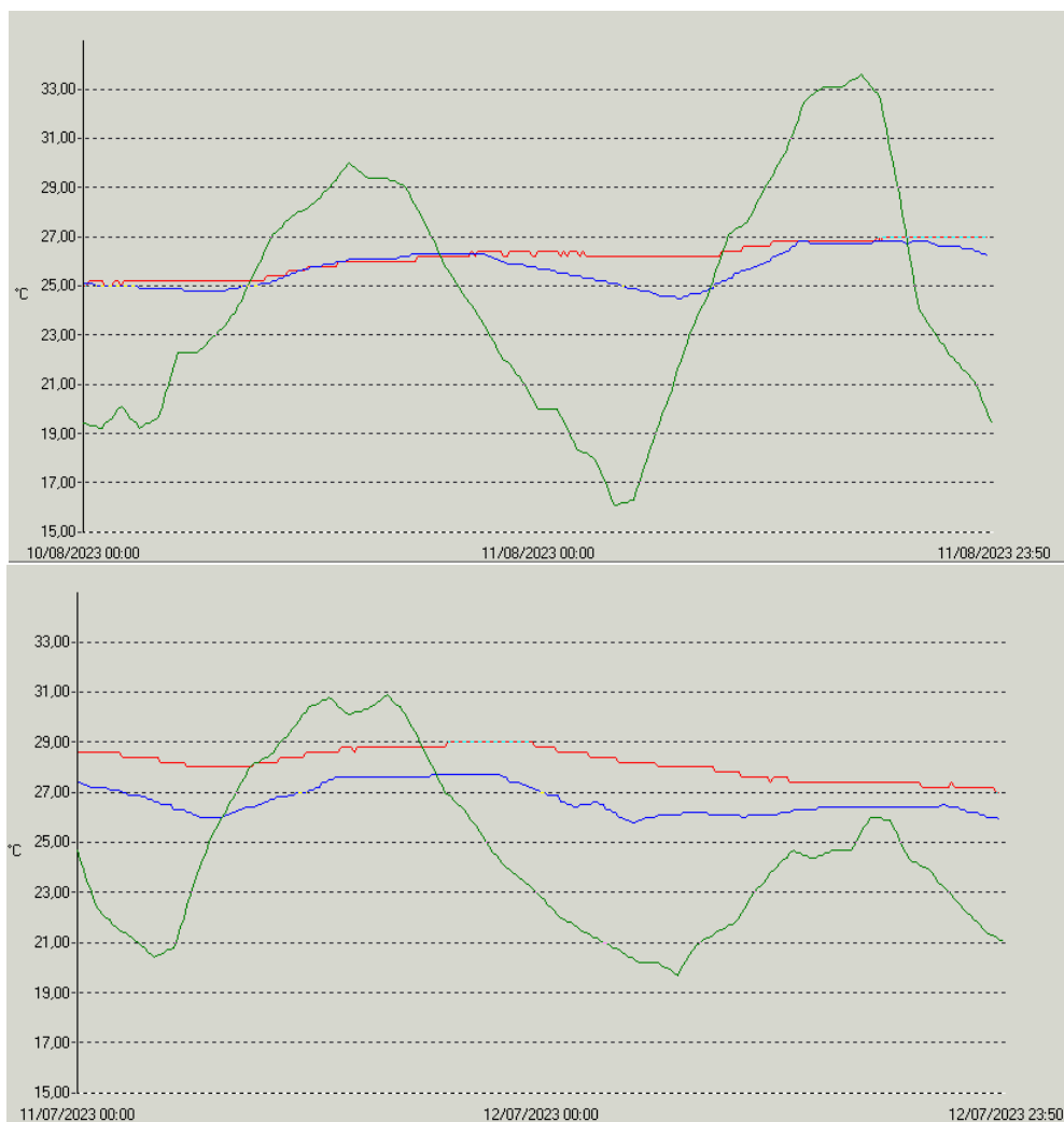
Figure 24 : Illustration de l'évolution du « confort qui prime » : températures extérieure (vert) et maintenues dans la chambre (rouge) et le séjour (bleu) pour les nuits des 10-11/08 et 11-12/07
